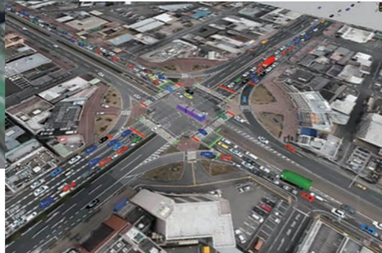
(一般道路の交差点の車線運用改善策による交通挙動を再現)
