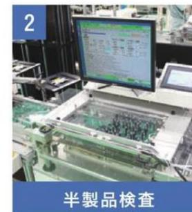
プリント基板のはんだ付けの状態や機能・性能の確認をする検査。熟練作業者による目視、3D外観検査装置、治具を使い確認します。
