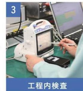
プリント基板と他の部品を組み立てて製品の動作を確認。製品のプログラムや言語のインストール、調整、治具を使った機能・性能の検査までを行います。
