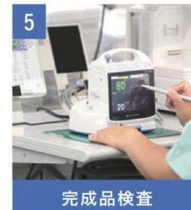
最後に耐電圧、漏れ電流、電源入力などの安全に関わる検査をはじめ、製品の品質や機能・性能、安全性について総合的に確認します。
