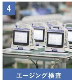
電子機器は使用開始直後に故障が起きやすい傾向があります。そのため、完成した製品に一定時間の通電負荷をかけるエージング検査を行い、初期不良を取り除きます。
